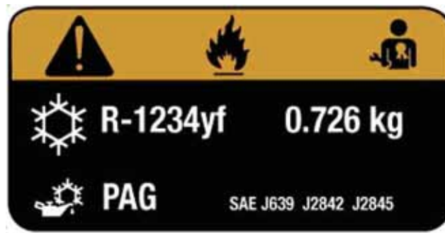
Beispiel Hinweisschild in einem Kfz mit R1234yf
